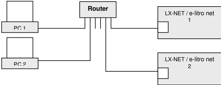
PC und Anzeigegerät sind an einem lokalen Netzwerk (LAN / Intranet ) direkt angeschlossen. Voraussetzung ist jeweils, dass das Anzeigegerät und der PC sich im gleichen Netzwerksegment befinden oder sich über entsprechende Router „sehen“ können.
