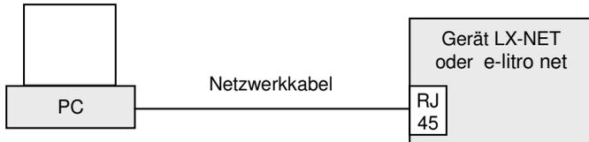
PC/Laptop mittels Netzkabel (cross-over) direkt mit der Gerätebuchse verbinden.
