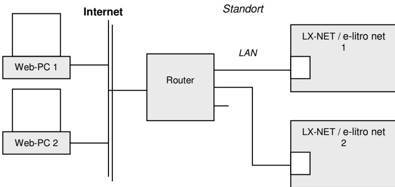
PC und Anzeigegerät sind an einem lokalen Netzwerk angeschlossen. Die Geräte sind im Intranet / LAN sichtbar. Durch Port-Forwarding im Router können die Geräte von extern über das Internet erreicht werden. Einrichtung siehe Abschnitt 5.
