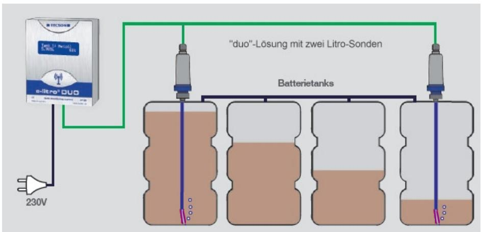
LITRO-Sonden direkt auf dem Öltank eingeschraubt. Einschraubgewinde G1" oder G1.5"
