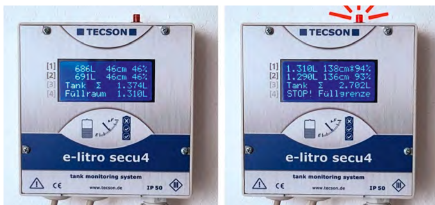
Bild 3: Anzeige vor dem Betanken – Füllfreiraum 1.310 Liter; rechts: Anzeige nach dem Grenzwert-Stop – „STOP! Füllgrenze“
